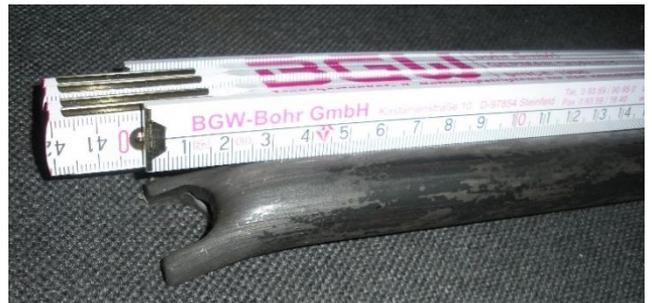
Länge der Rohrquerstrebe für Ankerbügel Laststufe 3,7t = Betonwandstärke - 74mm, für 4,5t - 75mm, für 5,8t - 78mm, für 8,5t - 82mm
