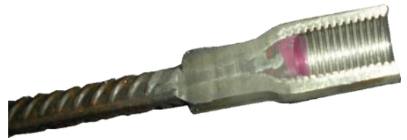
Die Abbildung zeigt einen aufgeschnittenen Transportanker mit dieser Versiegelung.
