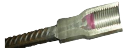
Die Abbildung zeigt einen aufgeschnittenen Transportanker mit dieser Versiegelung.
