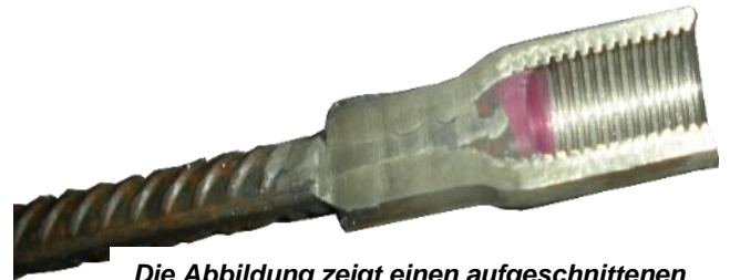
Die Abbildung zeigt einen aufgeschnittenen Transportanker mit dieser Versiegelung.
