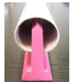
Kammerschwert mit Schlitzrohr
