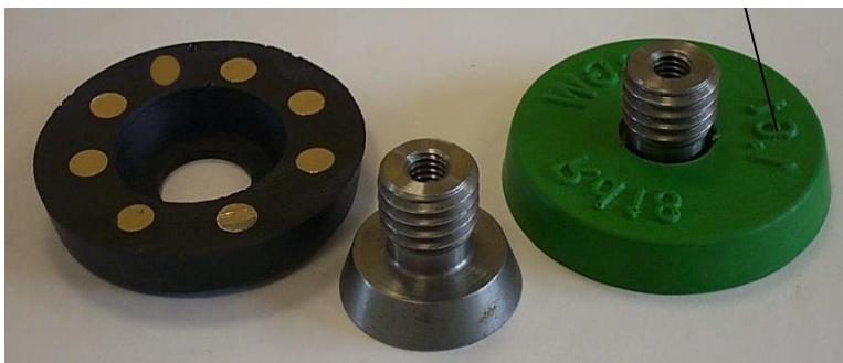
BGW-Aussparungskörper mit Kennzeichnung
