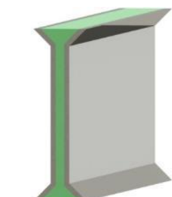
Schalleiste mit beidseitiger Fase – unten und oben-
